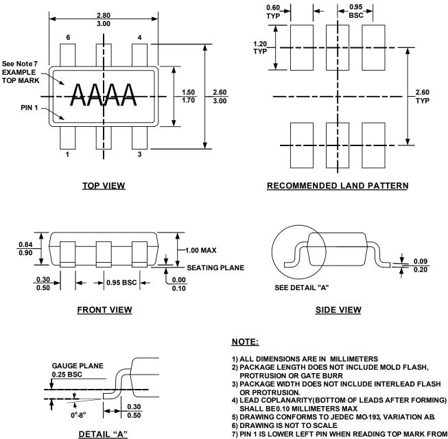
7) PIN 1 IS LOWER LEFT PIN WHEN READING TOP MARK FROM LEFT TO RIGHT, (SEE EXAMPLE TOP MARK)
